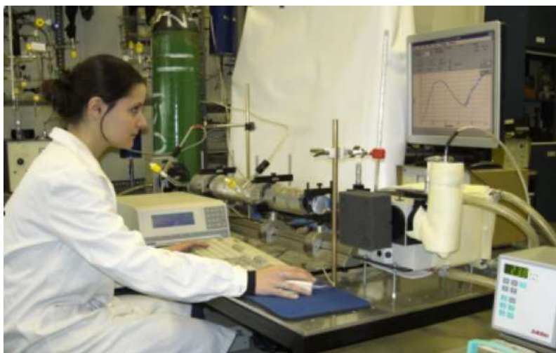
10. ábra. Saját műszerfejlesztéssel készült UV-VIS spektrométer gázminták abszorpciós spektrumának meghatározására
