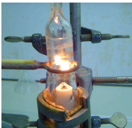
11. ábra. Iridium egykristály előkészítése méréshez: 2000 °C-os hevítés argonáramban
